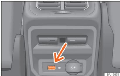
**Abb. 237** Mittelkonsole hinten: USB-Anschlüsse.
