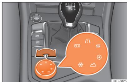
**Abb. 249** Mittelkonsole: Drehknopf (Driving Experience button).
