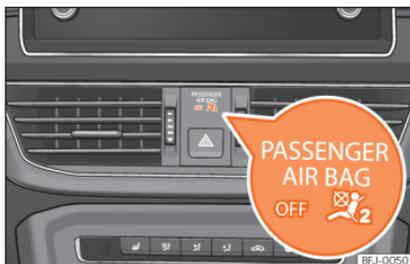
**Abb. 19** Instrumententafel: Kontrollleuchte für Abschaltung des Beifahrerairbags.
