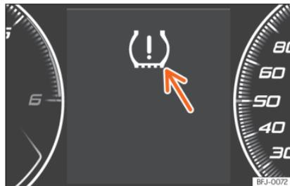
Abb. 322 Kombi-Instrument: Warnung Reifendruckverlust.
