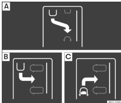
**Abb. 283** Am Bildschirm des Kombi-Instruments: Anzeige der Parkmodi.
