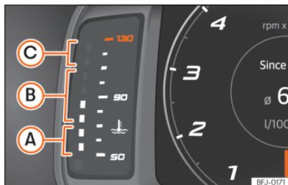
Abb. 63 Frei konfigurierbares Kombiinstrument: Motorkühlmittel-Temperaturanzeige.
