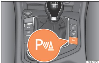
Abb. 288 Mittelkonsole: Taste für Einparkhilfe.
