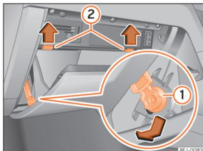
**Abb. 53** Handschuhfach (Rechtslenker): Zugang zum Sicherungskasten.
