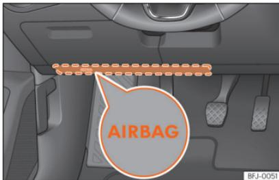
**Abb. 20** Auf der Fahrerseite: Einbauort des Knieairbags.
