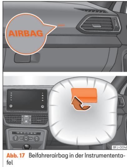
Abb. 17 Beifahrerairbag in der Instrumententafel
