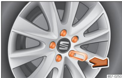
**Abb. 36** Rad: Radschrauben mit Deckel.
