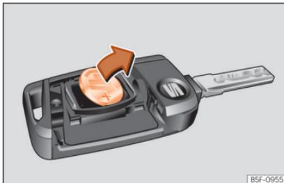
**Abb. 74** Fahrzeugschlüssel: Batterie herausnehmen.
