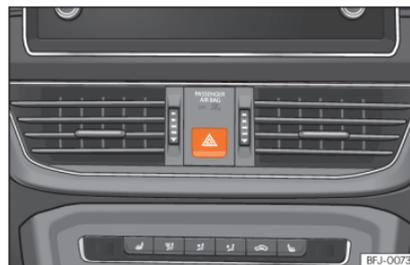
**Abb. 98** Instrumententafel: Schalter für Warnblinkanlage.
