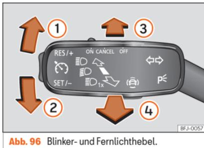
Abb. 96 Blinker- und Fernlichthebel.
