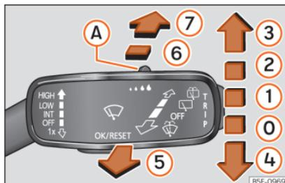
**Abb. 101** Bedienung von Windschutz- und Heckscheibenwischer
