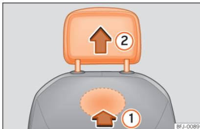
**Abb. 113** Kopfstützen vorne: Ausbau.
