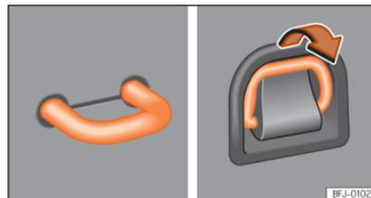
Abb. 131 Im Gepäckraum: feststehende und herausklappbare Verzurrösen.
