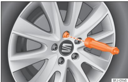
**Abb. 42** Radwechsel: Radschrauben mit dem Schraubendrehergriff herausdrehen.
