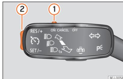
**Abb. 252** Am Blinkerhebel: Bedienelemente zur Bedienung der GRA.
