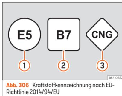
Die Kraftstoffe werden mit verschiedenen Symbolen gekennzeichnet, die sich an der Zapfpistole und am Tankdeckel Ihres Fahrzeugs befinden. Diese Kennzeichnung dient dazu, Verwechslungen bei der Auswahl des Kraftstoffs zu vermeiden.
