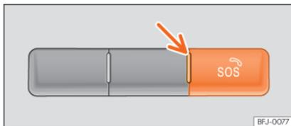
**Abb. 32** In der Dachkonsole: Taste für Notruf-Service
