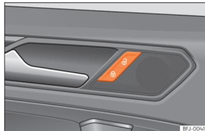
Abb. 76 Fahrertür: Zentralverriegelungstaster.
