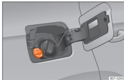
**Abb. 308** Verschlussdeckel des AdBlue-Tanks
