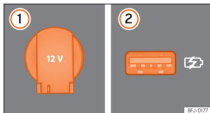
**Abb. 150** ① 12-Volt-Steckdose. ② USB-Steckdose im hinteren Bereich der Mittelkonsole.
