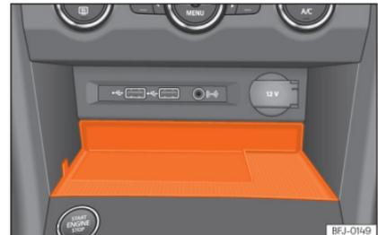
**Abb. 239** In der Mittelkonsole: Aufnahme für die Mobiltelefonkopplung.
