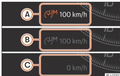
**Abb. 253** Am Bildschirm des Kombi-Instruments: Statusanzeigen des Geschwindigkeitsbegrenzers.
