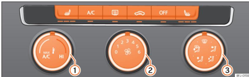
**Abb. 154** In der Mittelkonsole: Bedienungselemente für die Klimaanlage.
