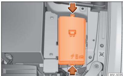
**Abb. 54** Im Motorraum: Abdeckung des Sicherungskasten.
