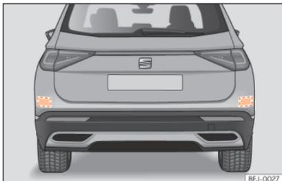
**Abb. 274** Heckansicht des Fahrzeugs: Bereich der Radarsensoren.
