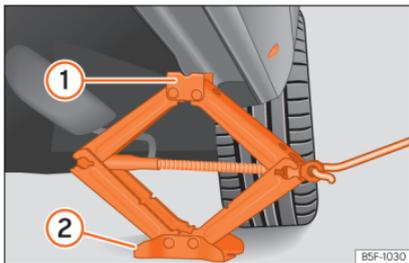
**Abb. 41** Längsholm: Wagenheber ansetzen.
