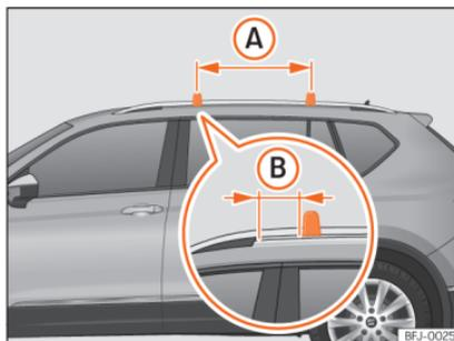
**Abb. 138** Befestigungspunkte der Längsträger für den Dachgepäckträger.
