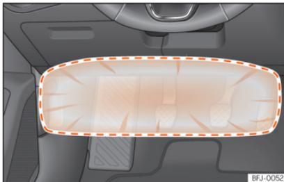
**Abb. 21** Auf der Fahrerseite: Wirkungsbereich des Knieairbags.
