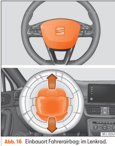
Abb. 16 Einbauort Fahrerairbag: im Lenkrad.
