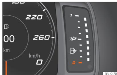
**Abb. 62** Frei konfigurierbares Kombiinstrument: Kraftstoffvorratsanzeige
