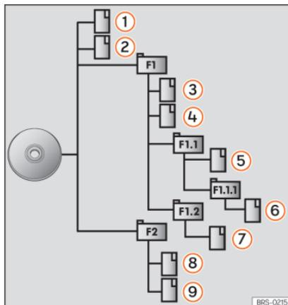
**Abb. 188** Mögliche Struktur einer Audiodaten-CD.
