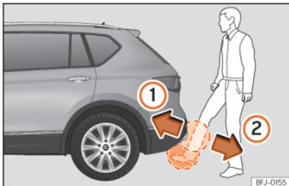
**Abb. 87** Heckklappe mit sensorgesteuerter Öffnung (Easy Open).
