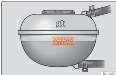
**Abb. 315** Im Motorraum: Markierung an dem Motorraumkühlmittelausgleichsbehälter.
