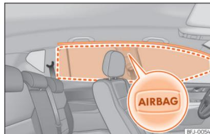
**Abb. 23** Einbauort der Kopfairbags
