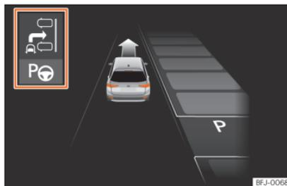
**Abb. 282** Am Bildschirm des Kombi-Instruments: Anzeige des Parklenkassistenten mit eingeschränkter Sicht.
