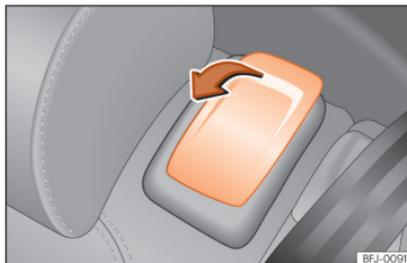
**Abb. 116** Zweite Sitzreihe: Bedienungselemente der Einstiegsilfe.
