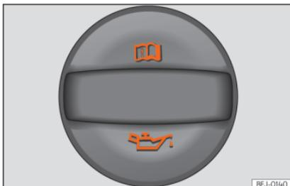
**Abb. 314** Deckel der Motoröl-Einfüllöffnung im Motorraum
