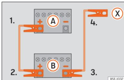
**Abb. 46** Anschlusschema für Fahrzeuge ohne Start-Stopp-System.
