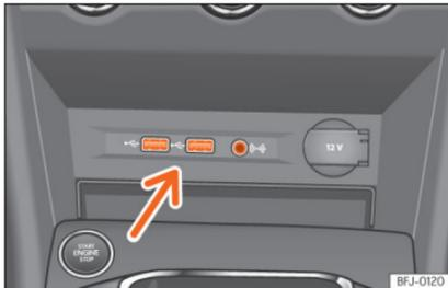
**Abb. 236** Mittelkonsole: USB/AUX-IN Anschluss.
