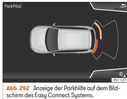
**Abb. 292** Anzeige der Parkhilfe auf dem Bildschirm des Easy Connect Systems.
