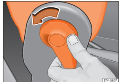
**Abb. 118** Klappbare Beifahrersitzlehne entriegeln.
