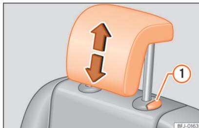
**Abb. 114** Hintere Kopfstützen ausbauen: Zweite Sitzreihe.
