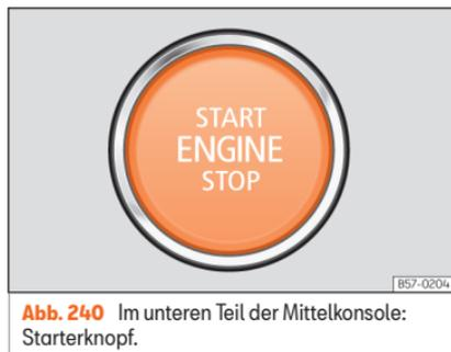
**Abb. 240** Im unteren Teil der Mittelkonsole: Starterknopf.
