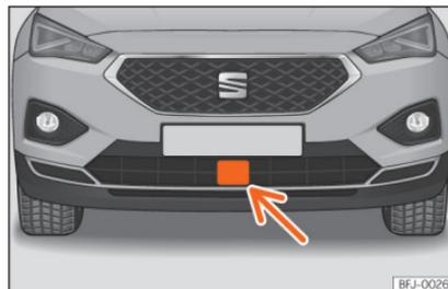
**Abb. 258** Am vorderen Stoßfänger: Radarsensor.
