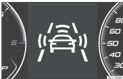
Abb. 257 Am Bildschirm des Kombi-Instruments: Anzeigen der Vorwarnung.
