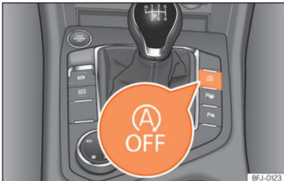
**Abb. 243** Mittelkonsole: Taste des Start-Stopp-Systems.
