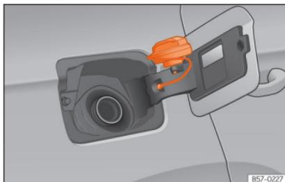
**Abb. 305** Tankklappe mit aufgestecktem Tankverschluss.
