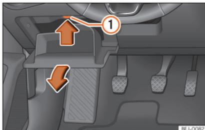
**Abb. 52** Auf der Fahrerseite in der Instrumententafel (Linkslenker): Abdeckung des Sicherungskastens.
