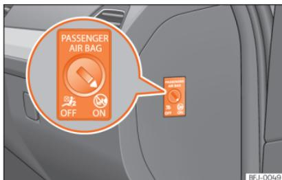
**Abb. 18** Schlüsselschalter zum Ein- und Abschalten des Beifahrerairbags.
