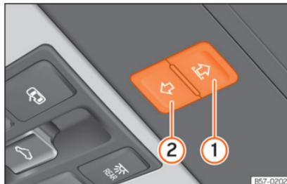
**Abb. 91** Im Dachhimmel: Tasten des Sonnenschutzrollos.
