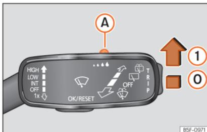
Abb. 102 Scheibenwischerhebel: Regensensor einstellen (A).
