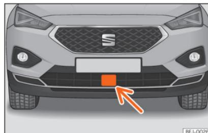
**Abb. 264** Am vorderen Stoßfänger: Radarsensor.
