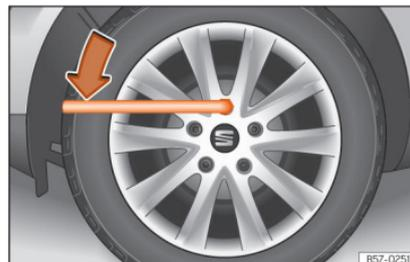
**Abb. 38** Radwechsel: Radschrauben lockern.
