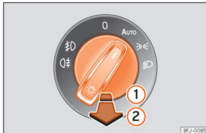
**Abb. 95** Instrumententafel: Lichtschalter.
