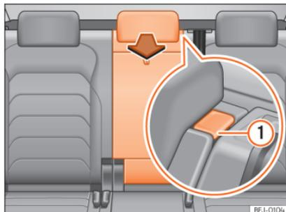
**Abb. 134** Rücksitzlehne: Öffnung der Durchladeeinrichtung.
