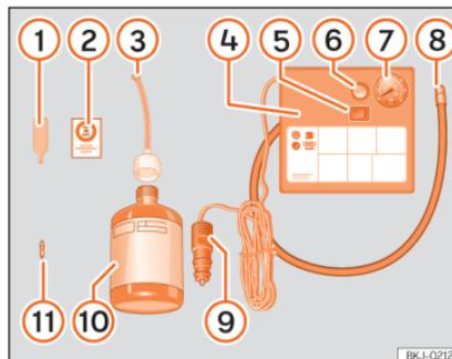
**Abb. 34** Prinzipdarstellung: Bestandteile des Pannensets.
