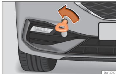
**Abb. 213** Vorderer Stoßfänger rechts: Eingeschraubte Abschleppöse
