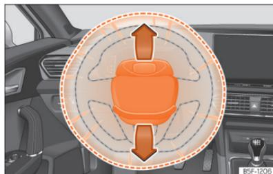
Abb. 25 Einbauort Fahrerairbag: im Lenkrad.
