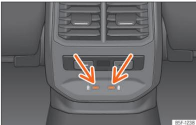
**Abb. 167** Mittelkonsole hinten: USB-Anschlüsse mit Steckdosenfunktion.
