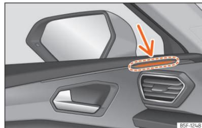
**Abb. 145** Kontrollleuchte des Spurwechselassistenten.
