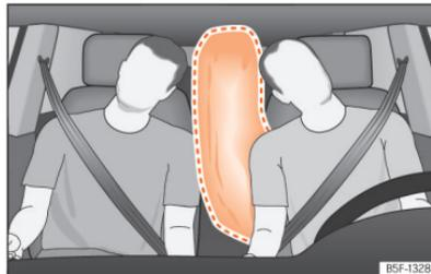
**Abb. 30** Vollständig entfalteter Center-Airbag (Entfaltungsbereich)
