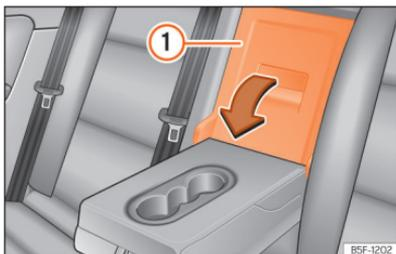
**Abb. 194** An der Rücksitzlehne: Öffnung der Durchladeeinrichtung.
