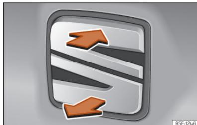
Abb. 79 Heckklappe: Öffnen von außen
