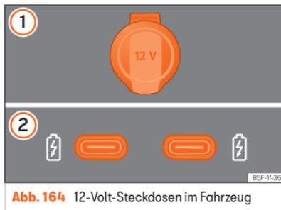
**Abb. 164** 12-Volt-Steckdosen im Fahrzeug
