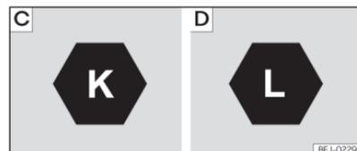
**Abb. 55** Kennzeichnung Gleichstrom (DC) und CCS-Fahrzeugstecker
