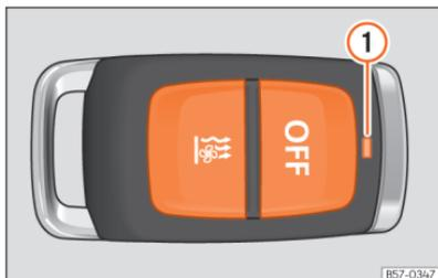
**Abb. 116** Standheizung: mit Funkfernbedienung
