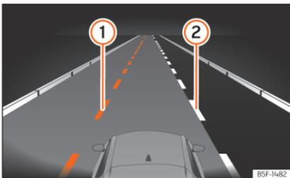
**Abb. 141** Im Display des Kombi-Instruments: Anzeigen des Spurhalteassistenten.
