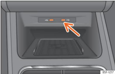
**Abb. 166** Mittelkonsole: USB-Eingang.
