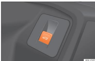
**Abb. 81** An der Fahrertür: Taste zum Öffnen und Schließen der Heckklappe.
