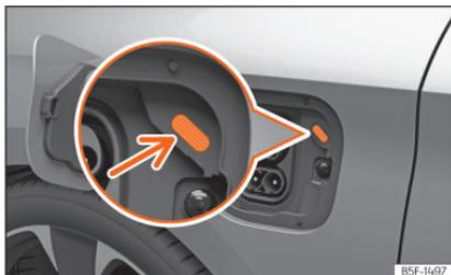
**Abb. 60** Hinter der Batterieladeflappe: Ladevorgangsanzeige.
