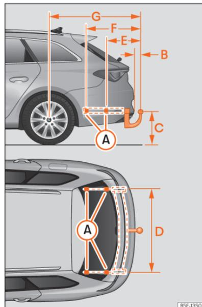
**Abb. 202** Maße und Befestigungspunkte für den nachträglichen Einbau einer Anhangervorrichtung
