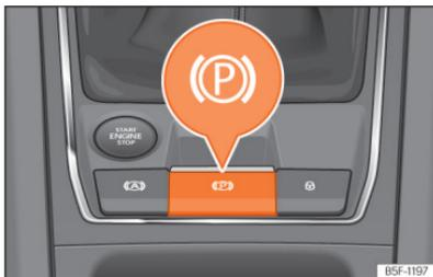
**Abb. 149** Im unteren Bereich der Mittelkonsole: Taste fr die elektronische Parkbremse.
