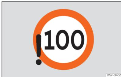
**Abb. 8** Am Bildschirm des Kombi-Instruments: Überschreitung der zulässigen Höchstgeschwindigkeit festgestellt [Abbildung].
