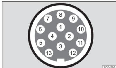
**Abb. 198** Schematische Darstellung: Zuweisung der Steckverbinderstifte für Anhängerstrom.
