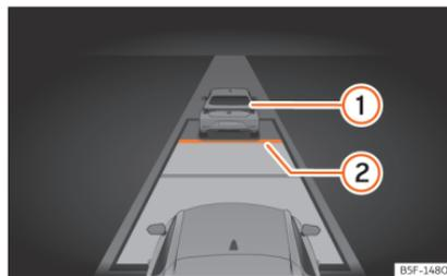
**Abb. 134** Am Bildschirm des Kombi-Instruments: ACC aktiv.
