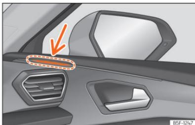
**Abb. 146** Kontrollleuchte des Spurwechselassistenten.
