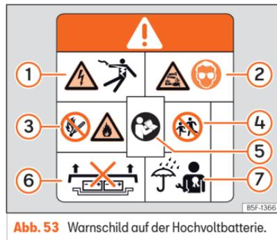
**Abb. 53** Warnschild auf der Hochvoltbatterie.
