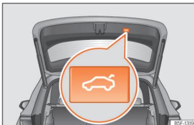
**Abb. 80** Heckklappe: Taste zum Schließen der Heckklappe.
