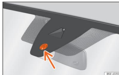
**Abb. 109** Sensitive Fläche des Regensensors.
