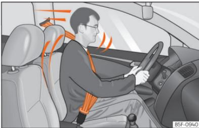
**Abb. 17** Richtig angegurtete Fahrer werden bei einem plötzlichen Bremsmanöver nicht nach vorne geschleudert.
