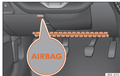
**Abb. 34** Auf der Fahrerseite: Einbauort des Knieairbags.
