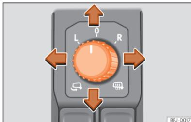
**Abb. 111** Ausschnitt der Fahrertür: Außenspiegelbedienung.
