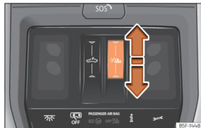
**Abb. 88** Im Dachhimmel: Sonnenschutzrollo bedienen.
