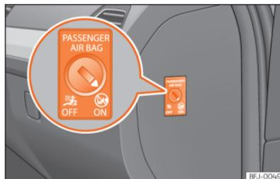
**Abb. 27** Schlüsselschalter zum Ein- und Abschalten des Beifahrerairbags.
