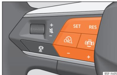
**Abb. 132** Am Multifunktionslenkrad: Tasten zur Bedienung des Geschwindigkeitsbegrenzers.
