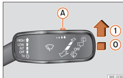
**Abb. 108** Scheibenwischerhebel: Regensensor (A) einstellen.
