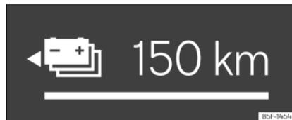
**Abb. 4** Digitales Kombi-Instrument: Anzeige des Batterieladezustands.
