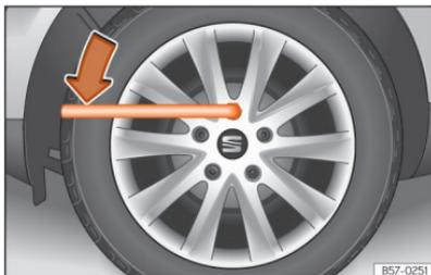
**Abb. 242** Radwechsel: Radschrauben lockern
