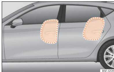
Abb. 32 Komplettaufgeblasener Seitenairbag auf der linken Fahrzeugseite.
