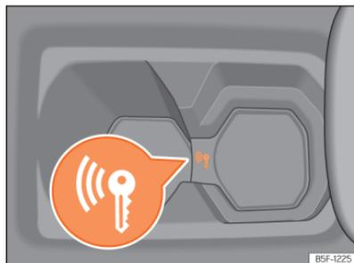
Abb. 118 In der Mittelkonsole: Notstart.
