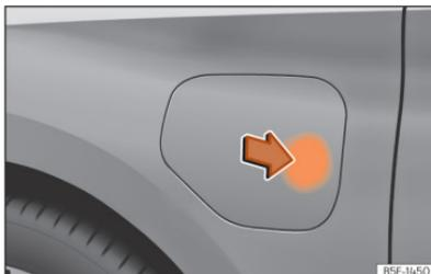
Abb. 56 Öffnung der Batterieladeklappe.
