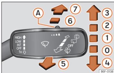
**Abb. 107** Bedienung von Frontscheibenwischer und Heckscheibenwischer
