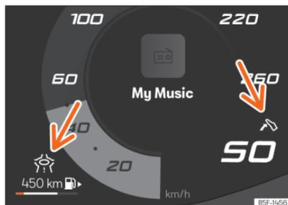
**Abb. 133** Anzeige Eco-Assistenz (schematische Darstellung)
