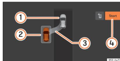
**Abb. 154** Am Bildschirm des Infotainment-Systems: Position zum längs einparken.
