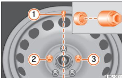
**Abb. 243** Radwechsel: Reifenventil ① und Einbauort der Anti-Diebstahl-Radschraube ② oder ③.
