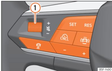
Abb. 89 Bedienelemente am Lenkrad
