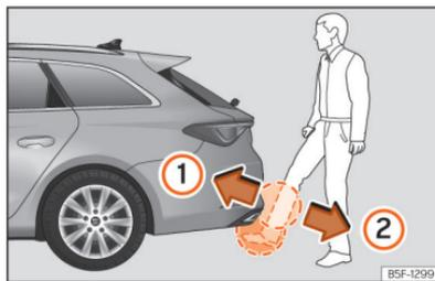
**Abb. 82** Heckklappe mit sensorgesteuerter Öffnung (Easy Open).
