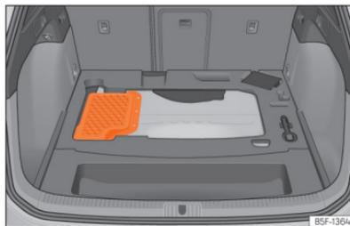
**Abb. 231** Plug-in-Hybridfahrzeuge (PHEV): Einbauort der Batterie im Kofferraum
