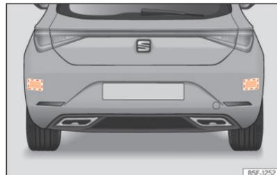
**Abb. 128** Bereich hinter dem Fahrzeug: Bereiche der Radarsensoren.
