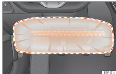
**Abb. 35** Auf der Fahrerseite: Wirkungsbereich des Knieairbags.
