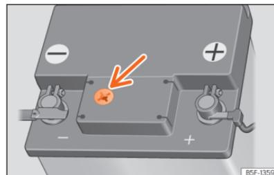
**Abb. 232** Sichtfenster an der Oberseite der 12-Volt-Fahrzeugaufbatterie (Prinzipdarstellung).
