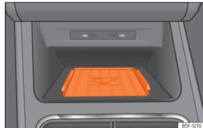
**Abb. 174** In der Mittelkonsole: Aufnahme für die Mobiltelefonkopplung.
