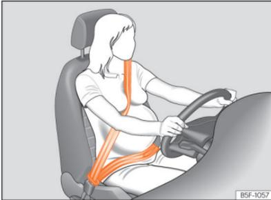
**Abb. 24** Gurtbandverlauf bei schwangeren Frauen.
