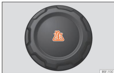
Abb. 223 Frontraum: Verschlussdeckel des Kühlmittelausgleichsbehälters.
