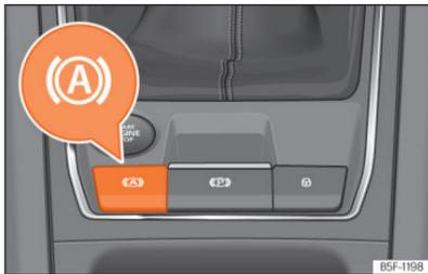
**Abb. 150** Im unteren Bereich der Mittelkonsole: Funktionstaste Auto Hold.
