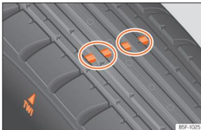
Abb. 235 Reifenprofil: Verschleißanzeiger.
