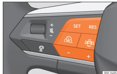
**Abb. 131** Am Multifunktionslenkrad: Tasten zur Bedienung der Geschwindigkeitsregelanlage.
