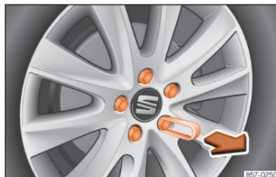
Abb. 240 Rad: Radschrauben mit Deckel.
