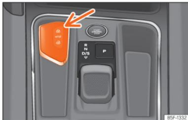
Abb. 68 Mittelkonsole (mit Automatikgetriebe): Aufnahme für den Fahrzeugschlüssel
