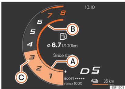
Abb. 5 Digitales Kombi-Instrument: Powermeter
