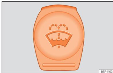
**Abb. 225** Im Motorraum: Blauer Deckel des Scheibenwaschwasserbehälters.
