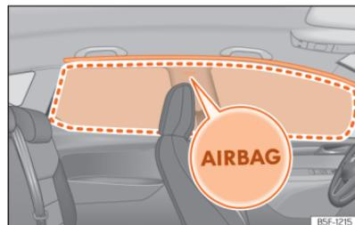
**Abb. 33** Einbauort und Entfaltungsbereich des Kopfairbags.
