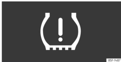
**Abb. 246** Kombi-Instrument: Warnung Reifendruckverlust.
