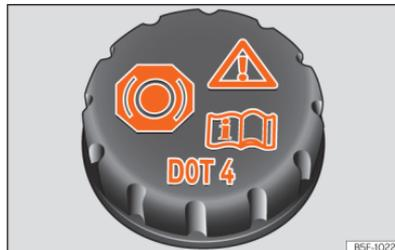
Abb. 224 Motorraum: Deckel des Bremsflüssigkeitsbehälters
