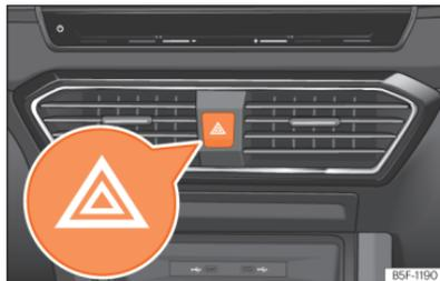
**Abb. 47** Instrumententafel: Schalter für die Warnblinkanlage
