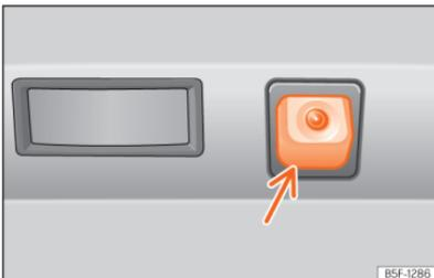
**Abb. 130** Im Stoßfänger hinten: Einbauort der Rückfahrkamera.
