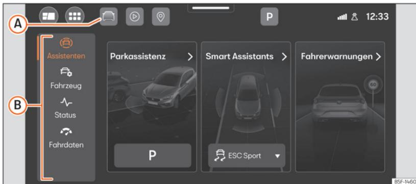
Durch Drücken auf » (Abb. 13) **A**) oder im Hauptmenü auf **Einstellungen Fahrzeug** öffnet sich das Menü der Assistenten und Fahrzeugeinstellungen. Beim anschließenden Drücken auf eines der Menüs im linken Bereich **B**) wird auf dem Bildschirm das ausgewählte Menü Einstellungen oder Assistenten angezeigt.
