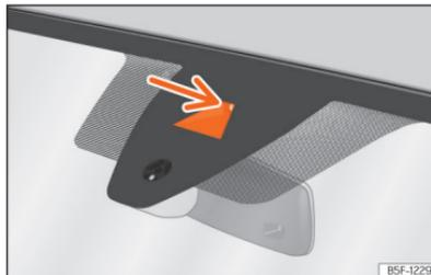
**Abb. 127** Kamerasichtfenster des Spurhalteassistenten.
