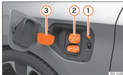
Abb. 59 Hinter der Batterieladeklappe hinten rechts: Ladedose.
