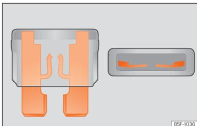
**Abb. 218** Darstellung einer durchgebrannten Sicherung.
