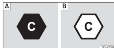
**Abb. 54** Kennzeichnung Wechselstrom (AC) und Stecker Typ 2.
