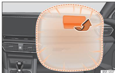
Abb. 26 Beifahrerairbag in der Instrumententafel
