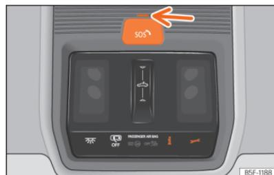
**Abb. 48** In der Dachkonsole: Schalter für Sprachdienste.
