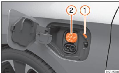
Abb. 57 Hinter der Batterieladeklappe vorn links: Ladedose
