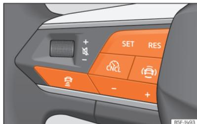
**Abb. 135** Am Multifunktionslenkrad: Tasten zur ACC-Bedienung.
