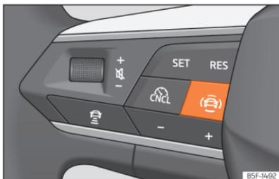
**Abb. 124** Linke Seite des Multifunktionslenkads: Taste für die Fahrerassistenzsysteme (modellabhängig).
