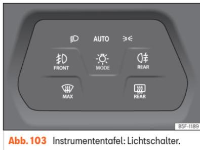
Abb. 103 Instrumententafel: Lichtschalter.
